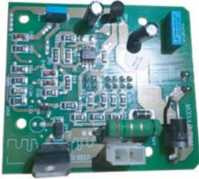
**08254** - Kit de Reparo para Dosador - Placa 7405V1 - Módulo PWM p/Módulo de bomba
